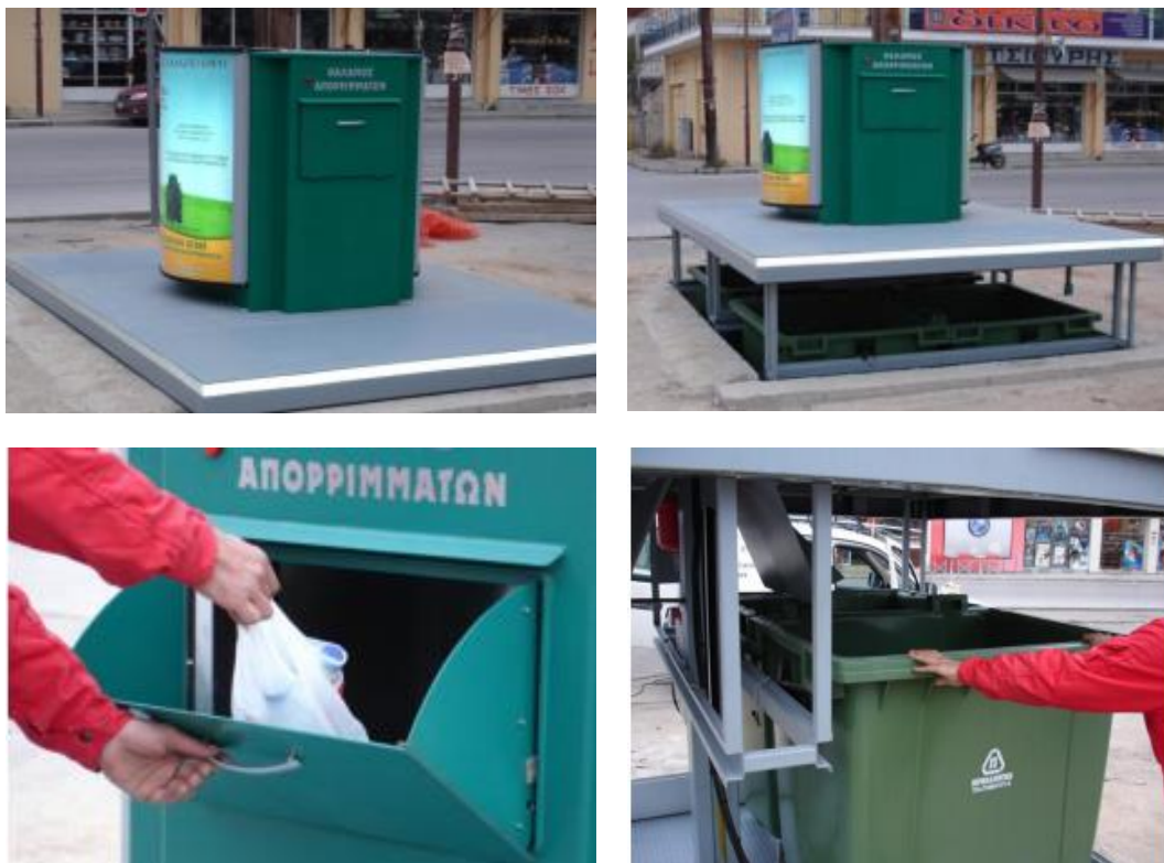
Εικόνα 7: Υπόγειοι κάδοι ανακύκλωσης (ενδεικτικές φωτογραφίες)
